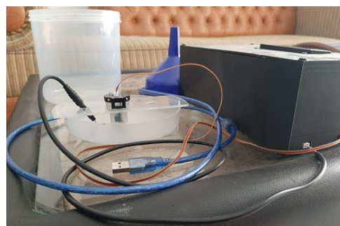
Gambar 10. Alat Pengukur Kualitas Air Bersih Tampak dari Atas dan Samping
