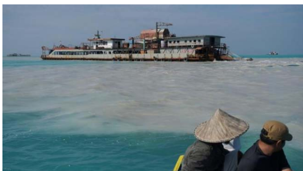
Gambar 1. Kapal Isap Produksi (KIP) timah yang beroperasi di perairan Bangka (Agustinus, 2018)
