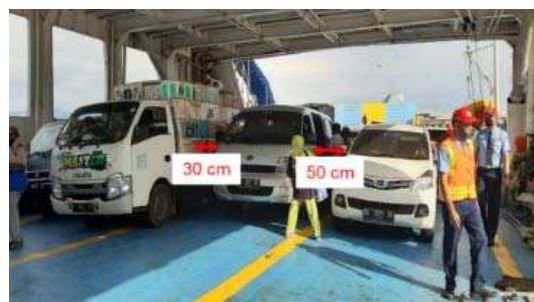
Gambar 6. Jarak antar mobil pada geladak kendaraan
