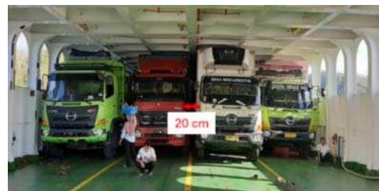
Gambar 5. Jarak antar truk pada geladak kendaraan
