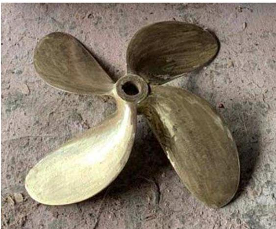
Gambar 2. *Propeller* kapal tipe *B-Series*
