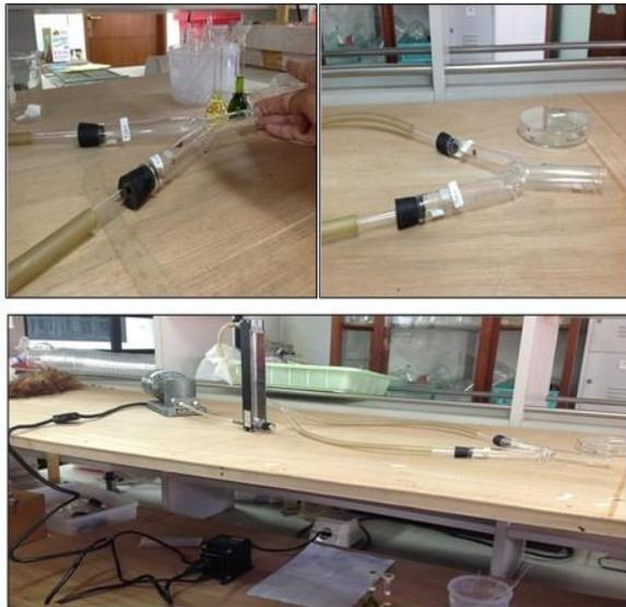
Gambar 2. Komponen uji preferensi serangga dengan pemasangan olfaktometer, serangga uji, dan bahan ekstrak tanaman
