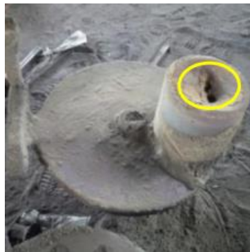
Gambar 10. Shrinkage terjadi pada riser [10]
