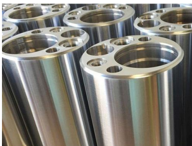
Hình 1. Chi tiết máy được phủ lớp mạ Crom [3]
