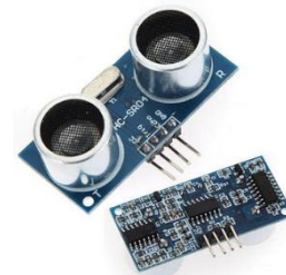
Gambar 3. Perangkat HC-SR04 untuk pengkondisian sinyal ultrasonik
