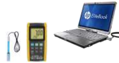
Gambar 4, Perangkat yang digunakan dalam penelitian: probe pH P-03, interface BPH-231, komputer (laptop)
