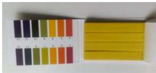
Gambar 9, Alat ukur pH manual 2 digit dengan kertas lakmus pH 1-14
