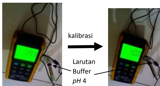
Gambar 8, Proses kalibrasi probe pH menggunakan larutan buffer pH 4
