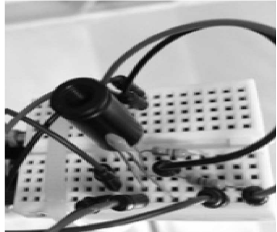
Hình 5. Mạch cảm biến MLX90614
