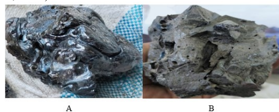
Gambar 3. (A). Penampakan morfologi hasil peleburan basalt normalizing , (B). Morfologi penampang bagian dalam hasil peleburan basalt normalizing .
