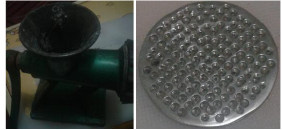
Gambar 2. Alat dan lubang pencetak sohun
