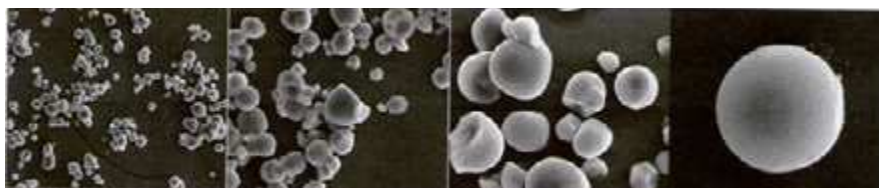
Gambar 1c. Hasil foto SEM sampel K1O2V1 (90% minyak kedelai + 3% lemak kakao + 7% lilin lebah, diaduk pada kecepatan 1.500 rpm)
