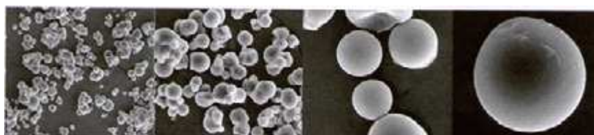
Gambar 1h. Hasil foto SEM sampel S1O2V2 (90% minyak sawit + 1% lemak kakao + 9% lilin lebah, diaduk pada kecepatan 25.000 rpm).
