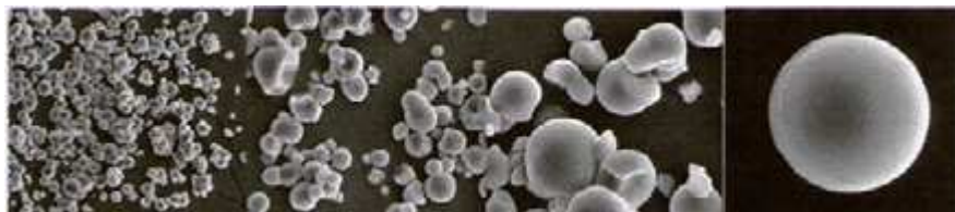
Gambar 1e. Hasil Foto SEM sampel S1O1V1 (90% minyak sawit + 1% lemak kakao + 9% lilin lebah, diaduk pada kecepatan 1.500 rpm).
