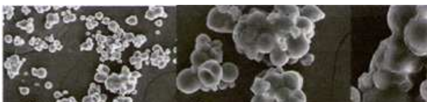
Gambar 1f. Hasil foto SEM sampel S1O1V2 (90% minyak sawit + 1% lemak kakao + 9% lilin lebah, diaduk pada kecepatan 25.000 rpm).
