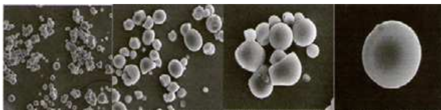
Gambar 1b. Hasil foto SEM sampel K1O1V2 (90% minyak kedelai + 1% lemak kakao + 9% lilin lebah, diaduk pada kecepatan 25.000 rpm )
