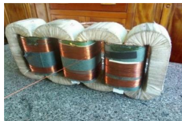
Hình 13. Công đoạn quấn dây cuộn SC và TC
