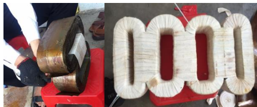
Hình 12. Công đoạn hoàn thiện mạch từ
