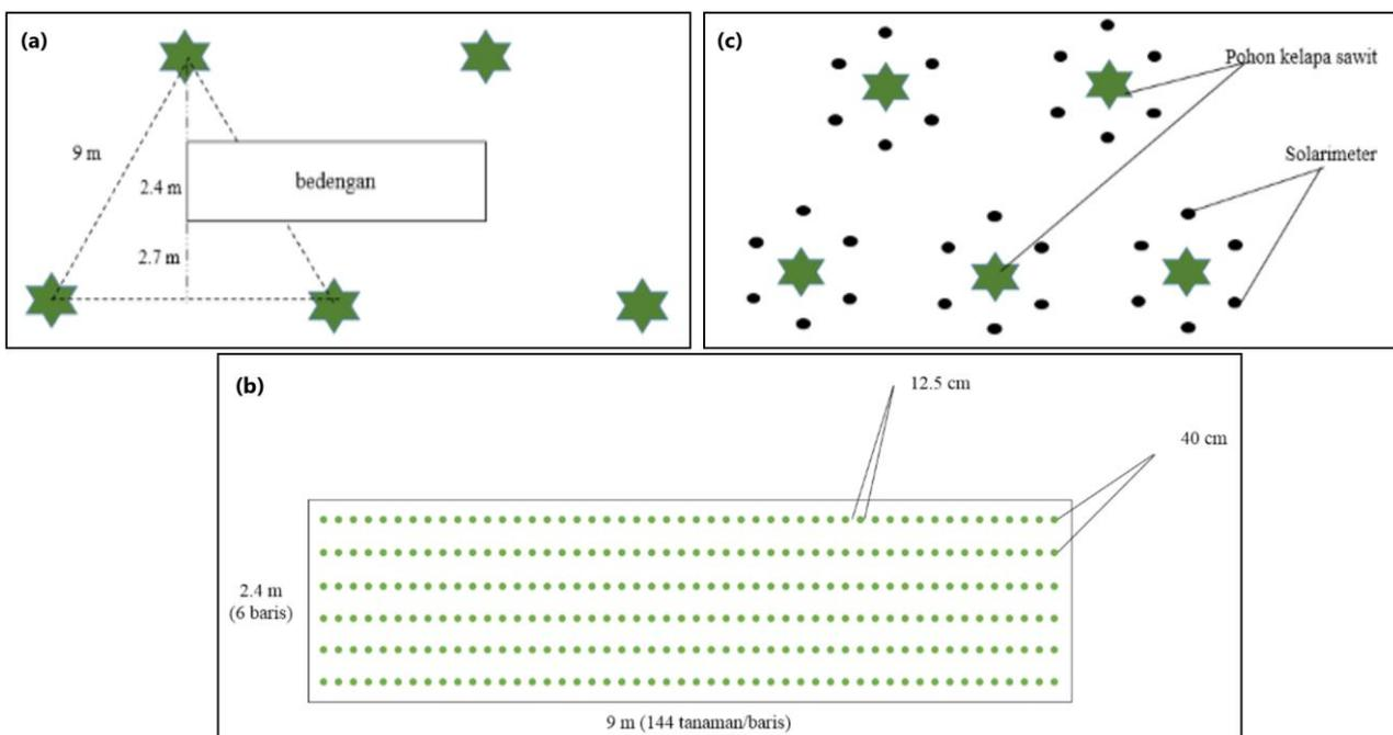
**Gambar 1.** Ilustrasi rancangan percobaan: (a) posisi bedengan pada lorong kelapa sawit, (b) ukuran bedeng dan populasi tanaman kedelai, dan (c) posisi titik pengukuran radiasi transmisi tanaman kelapa sawit umur empat tahun menggunakan metode *triangular*.
