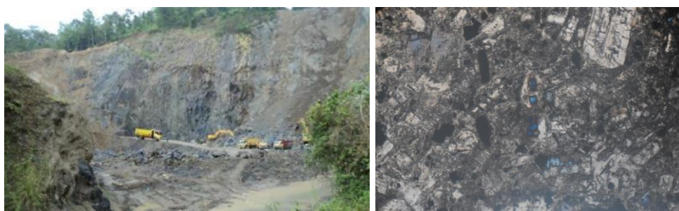
Gambar 7. Kekar tiang pada tubuh andesit yang sedang ditambang, serta foto mikroskop andesit di Desa Mangunweni
