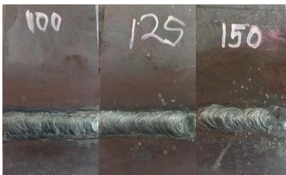
Gambar 6. Hasil pengelasan arus 100 A, 125 A, dan 150 A
