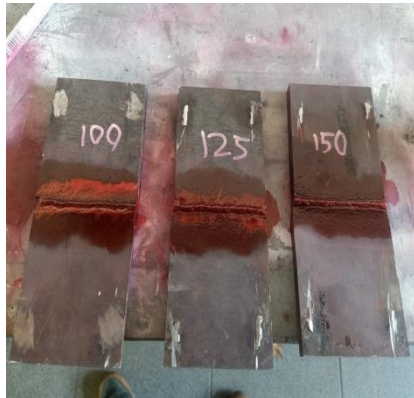
Gambar 4. Proses Pengujian NDT Penetrant Test
