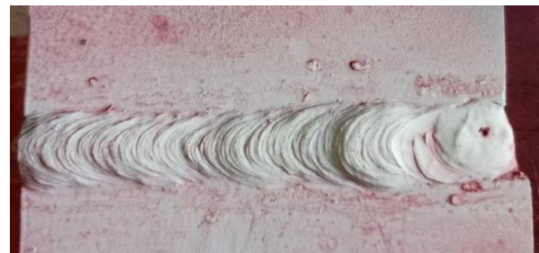
(b) Hasil pengujian NDT Penetrant Test pada arus 125 A
