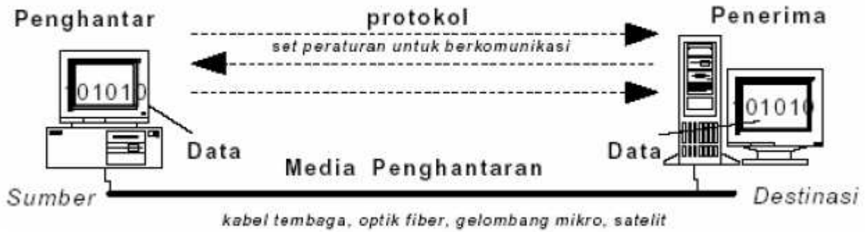
Gambar 1. Diagram Komunikasi Data
