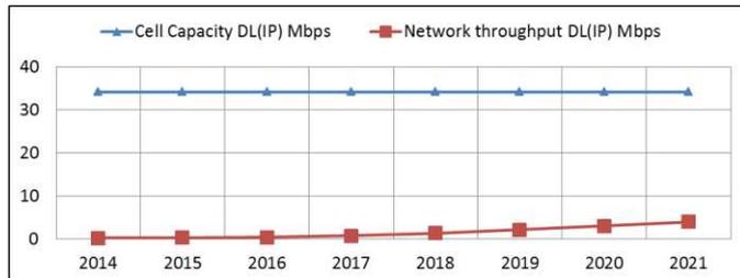
Gambar 49. Cell Capacity dan Network Throughput untuk Daerah Urban (skenario 6)
