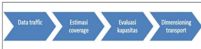
Gambar 10. Langkah-langkah dasar dimensioning jaringan selular
