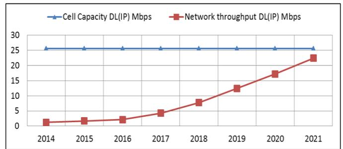
Gambar 44. Cell Capacity dan Network Throughput untuk Daerah Dense Urban (skenario 5)
