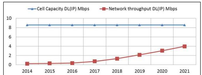
Gambar 37. Cell Capacity dan Network Throughput untuk Daerah Urban (skenario 3)
