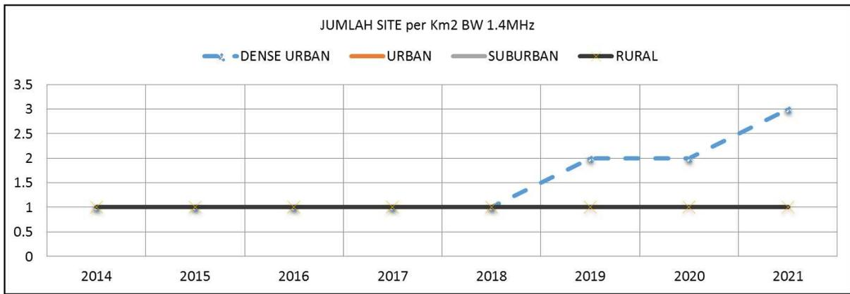
Gambar 17. Jumlah Site per km<sup>2</sup> Pada Bandwidth 1.4 MHz
