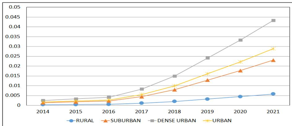
Gambar 24. . Estiamasi Penetrasi Pelanggan LTE/km<sup>2</sup> di Indonesia
