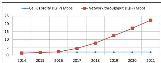
Gambar 28. Cell Capacity dan Network Throughput untuk Daerah Dense Urban (skenario 1)
