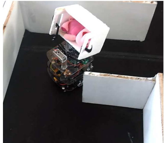
Gambar 14. Penelusuran dinding dengan membawa boneka pada robot Penyelamat dan Pemadam Api.
