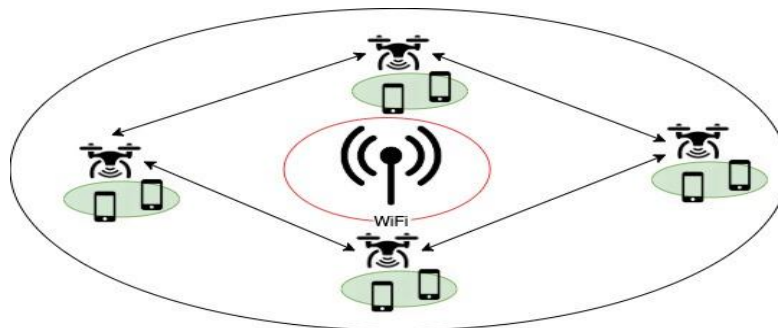
Рисунок 4 - Схема организации Wi-Fi сети с помощью БПЛА
