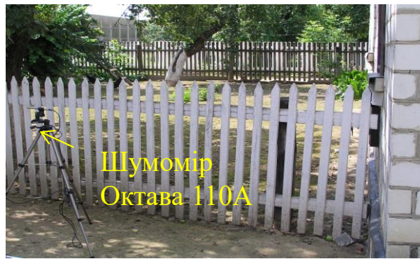
Рис. 1. Визначення рівня шуму: а – перед шумозахисним екраном на 238 км автомобільної дороги Київ-Чоп; б – біля житлового будинку в місці встановлення шумозахисного екрану
