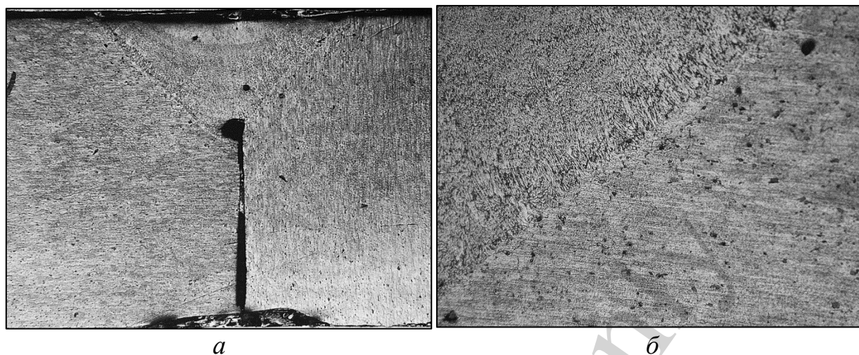
Рис. 8. Структуры лазерно-микроплазменного провара: а – общий вид, \times 50 ; б – зона сплавления с основным металлом, \times 250
