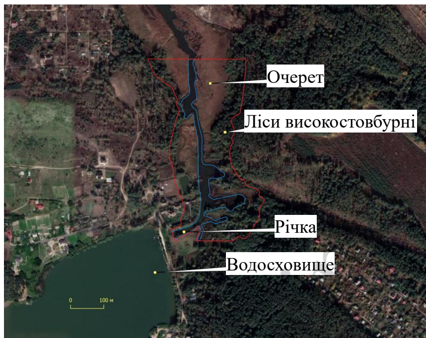
Рис. 1. Розташування розрахункової зони на області обчислення кінематики по-веневої течії на заплавної зоні у відмітках рівня високої води 144.5 м
