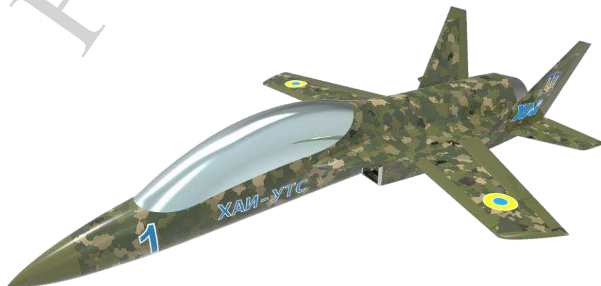
Рис. 3. Модель майстер-геометрії навчально-бойового літака
