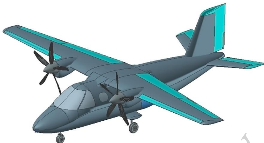
Рис. 8. Модель майстер-геометрії цивільного легкого літака
