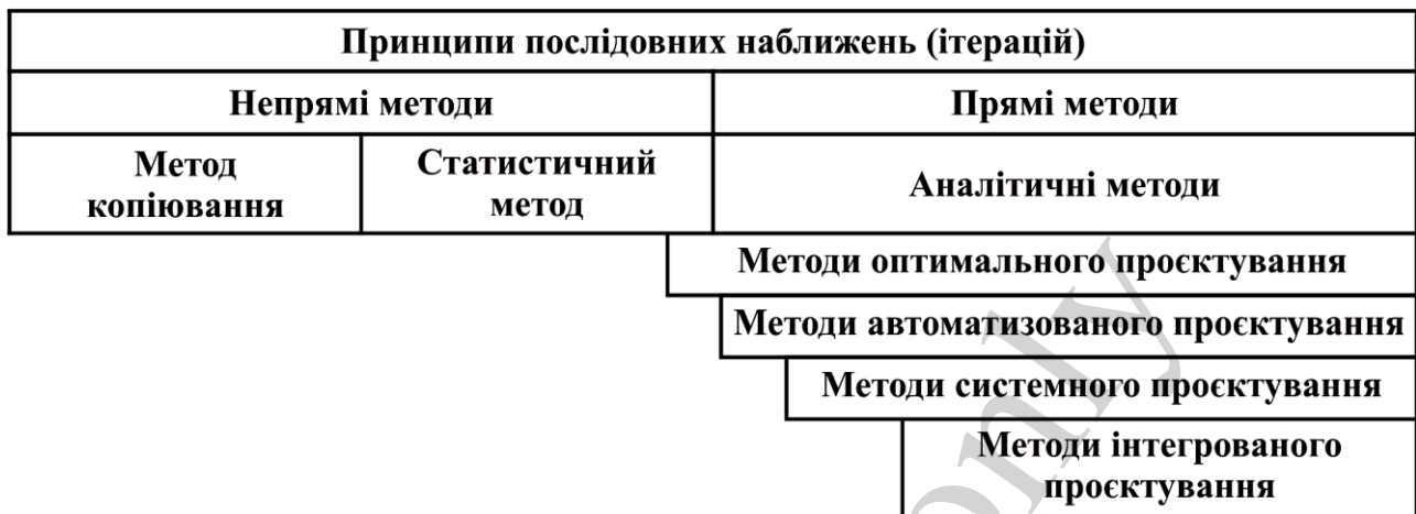
Рис. 1. Еволюція методів проєктування літаків
