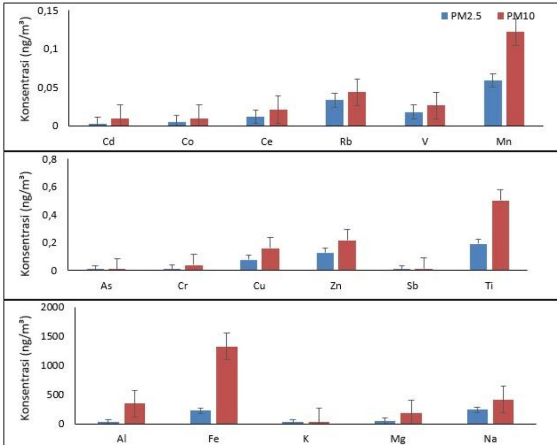
**Gambar 5.** Kandungan rerata unsur dalam sampel PM10 dan PM2.5 yang dilakukan simultan 24 jam
