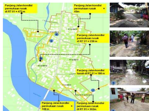
Gambar 3 Kondisi Jalan Lingkungan
