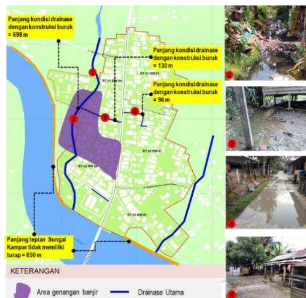
Gambar 5 Ketidakmampuan Mengalirkan Limpasan Air
