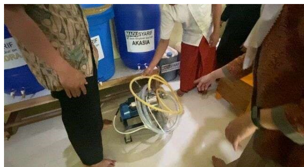
Gambar 3. Pompa Transfer Madu untuk membantu memindahkan madu dari jirigen ke drum
