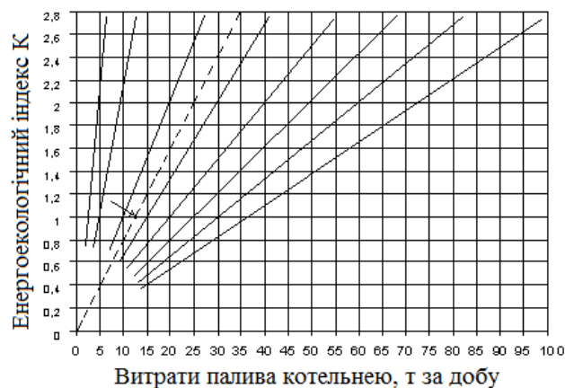
Рисунок 4 – Сімейство графіків відповідності енергоекологічного індексу K витратам палива для котельень потужності від 400 кВт до 50 МВт (пунктирна лінія відповідає потужності котельні 10 МВт).
