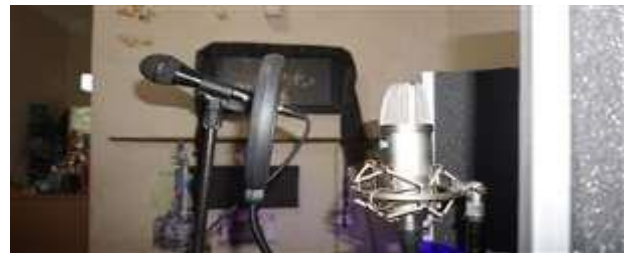
Gambar 7: Dynamic Microphone (kiri), Condenser Microphone (kanan) Foto oleh Faris, Agustus 2020
