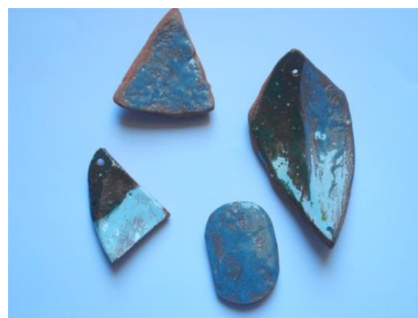
Gambar 8. Uji glasir III (Sumber Foto: Novierti Debby, 2017)
