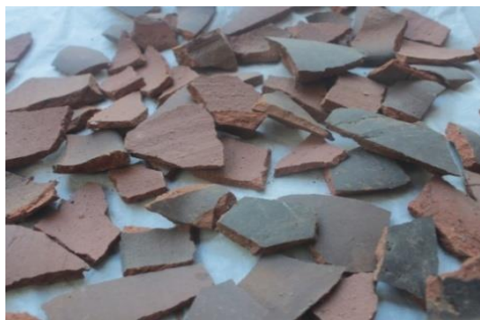
Gambar 4. Limbah keramik yang dipecah (Sumber Foto: Novierti Debby, 2017)
