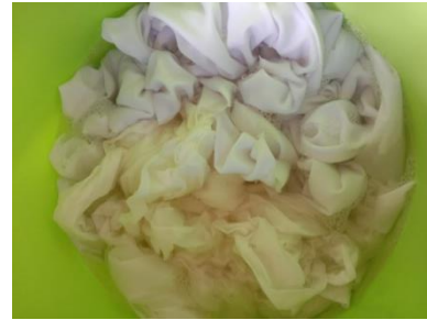
Gambar 1. Proses Scouring Sumber : Penulis 2020
