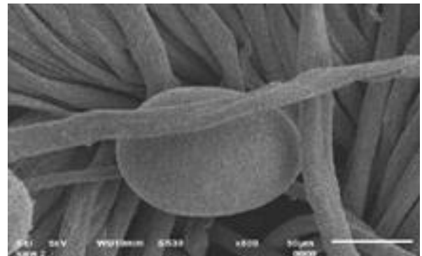
Gambar 6. Mikrograf SEM hasil imobilisasi mikro kapsul Sampel I perbesaran 500x
