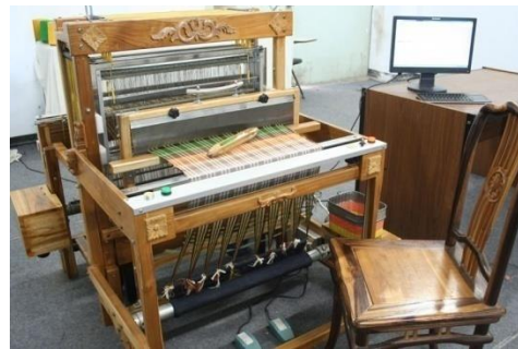
Gambar 3. ATBM Dobby Elektronik
