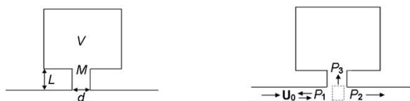
Gambar 1. Helmholtz Resonator dan Tekanan aliran
