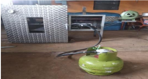
Gambar 1. Mesin pengering tipe rak dengan kapasitas 20kg
