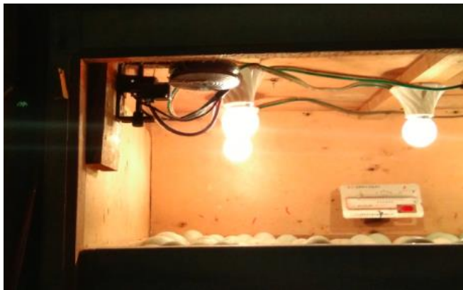
Gambar 7. Pengujian sistem hybrid dengan beban lampu pijar pada penetasan telur itik
