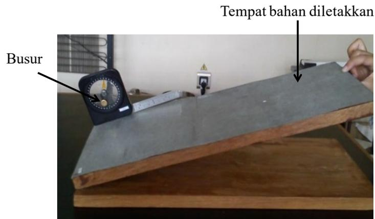
Gambar 5. Alat pengukur sudut repos
