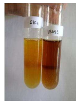
Gambar 3. Hasil uji senyawa terpenoid ditunjukkan dengan terbentuknya lapisan coklat diantara dua pelarut (tabung kanan)
