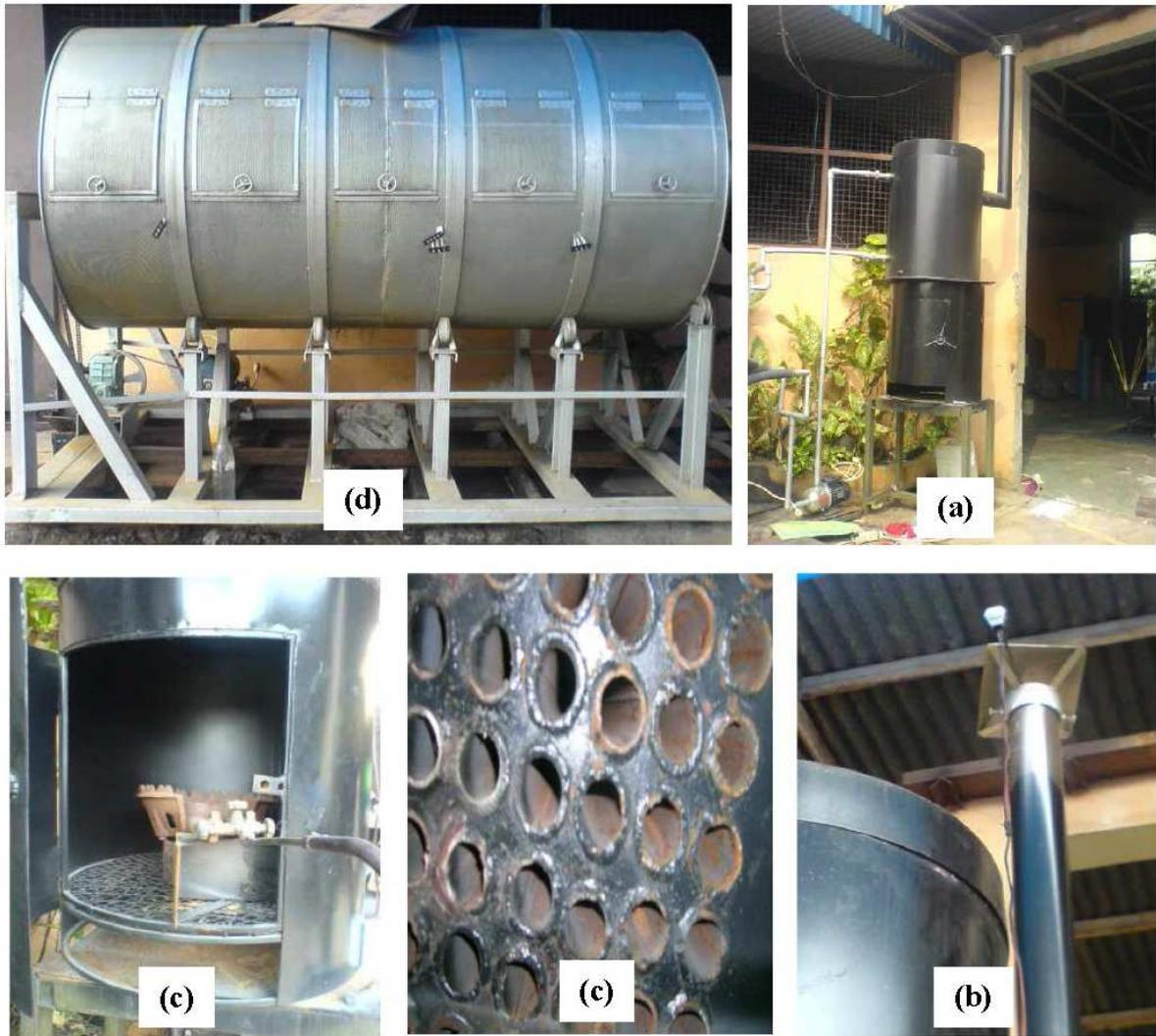
Gambar 1. Pengering tipe drum berputar yang dikembangkan: (a) subsistem tungku pembakaran, (b) subsistem tangki air, (c) subsistem penukar panas, dan (d) subsistem silinder pengering
