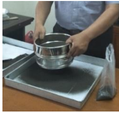
Gambar 12. Proses Penyaringan Conto Pasir Besi
