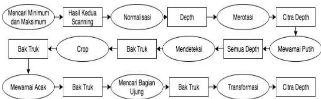
Gambar . 20. Arsitektur Sistem Pengambilan Bak Truk
