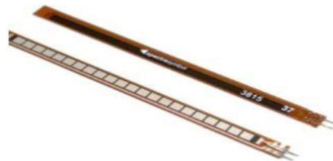
Gambar 2. Bentuk Fisik Sensor Flex [6]
