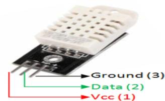
Gambar 3. Konfigurasi Pin DHT22
