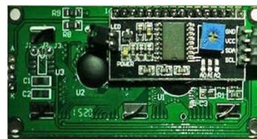
Gambar 7. Fisik tempat belakang LCD 20X4 dengan I2C
