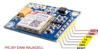
Gambar 13. Modul SIM800L V.2
