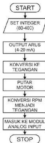
Gambar 9. Flowchart Rangkaian pengendali kecepatan motor
