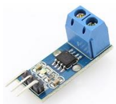
Gambar 10 (1) Modul sensor arus ACS712 dan (2) Rangkaian skematik sensor arus ACS712
