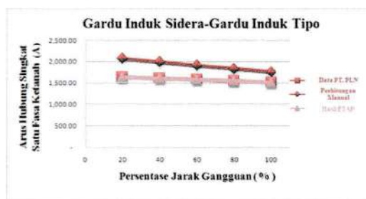
Gambar 18. Grafik Perbandingan Hasil Perhitungan Manual Dengan Data PT. PLN. Wilayah Suluttenggo AP2B Sistem Minahasa dan Software ETAP ( Electric Transient and Analysis Program )12.6.0.
