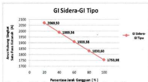
Gambar 16. Grafik Perbandingan Jarak Gangguan Terhadap Arus Gangguan Satu Fasa Ketanah.
