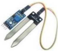
Gambar 2.5: Bentuk fisik sensor kelembapan YL-69 (Wijaya, 2017)
