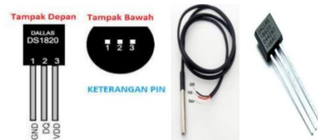
Gambar 2.4: Bentuk fisik sensor suhu DS18B20 (Akbar, 2017)
