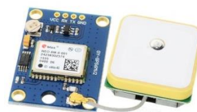
Gambar 4. Modul GPS Ublox NEO6M
