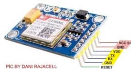
Gambar 5. Modul GSM SIM 800Lv2
