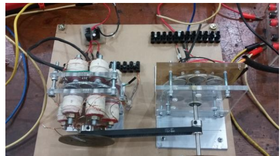
Gambar 13. Rangkaian motor brushless direct current 3 fasa fluks aksial dengan beban generator
